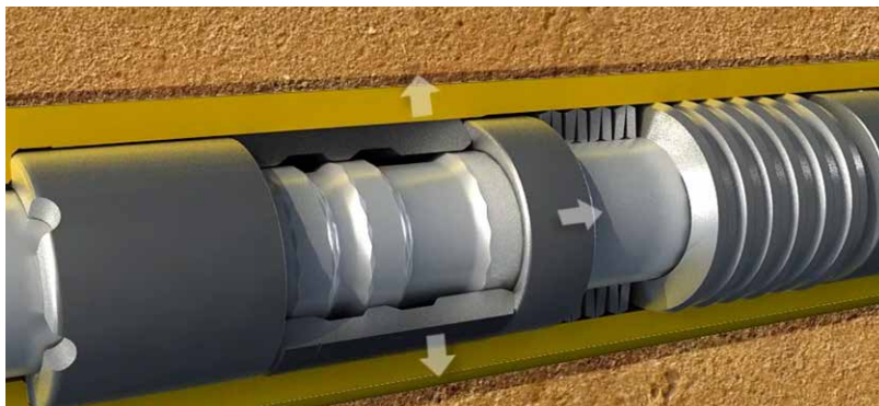
Imagen 1. Pestillo mecánico interno, propietario de Cougar, para evitar que el martillo dispare accidentalmente y elimina la necesidad de abrazaderas de seguridad externa.
